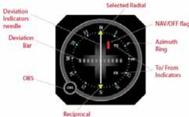
مؤشر (بوصله) جهاز الـ VOR في كيبنة الطائرة
