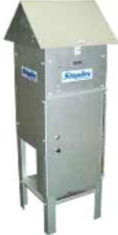
(هـ): جهاز ثابت لقياس الغبار عبر الفلتر
